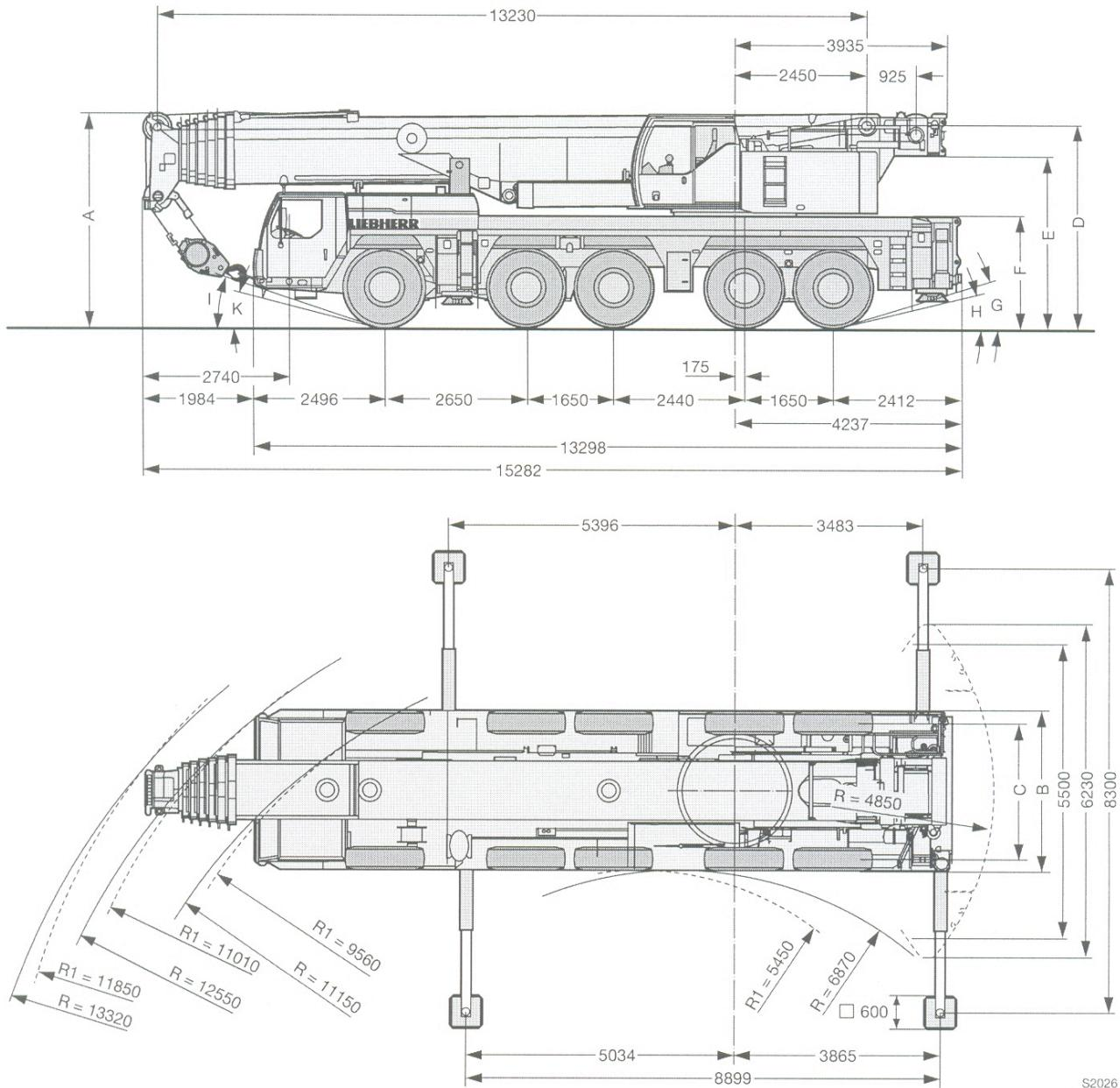
$R_1$  = Allradlenkung · All-wheel steering · Direction toutes roues · Tutti gli assi sterzanti · Dirección en todos los ejes · Поворот всеми колесами
